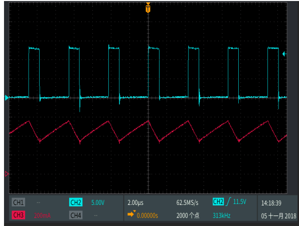
SW 脚与电感电流工作波形
